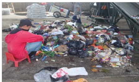
Gambar 1.2. Unit Pengelola Sampah (UPS). Kondisi fisik UPS dan suasana pemilahan sampah di dalam UPS, yang dilakukan secara manual, kemudian digiling menggunakan mesin, dan hasil penggilingan sampah organik diolah menjadi pupuk yang kemudian dijual ke masyarakat (Agustus, 2009).
