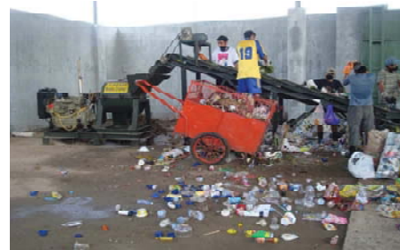
Gambar 1.2. Unit Pengelola Sampah (UPS). Kondisi fisik UPS dan suasana pemilahan sampah di dalam UPS, yang dilakukan secara manual, kemudian digiling menggunakan mesin, dan hasil penggilingan sampah organik diolah menjadi pupuk yang kemudian dijual ke masyarakat (Agustus, 2009).
